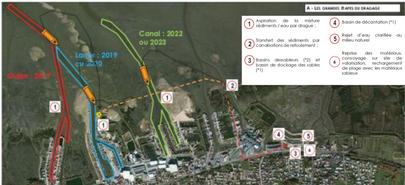
Figure 4. Schéma des opérations de dragage des chenaux d'accès et de des darses.
