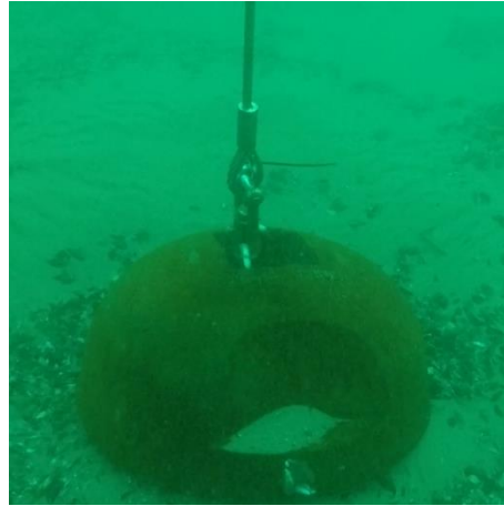
Figure 3 : Système d'ancrage et départ de la ligne de mouillage sans ragage au sol.
