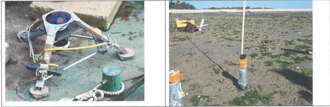
Figure 1: A gauche exemple de tripode avec ADCP, à droite capteur de pression sur cornière
